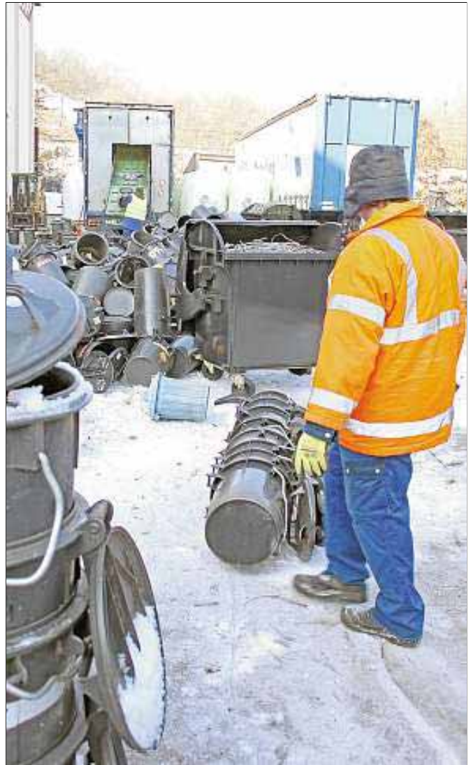
Nachdem die Tonnen auseinandergelöst sind, landen sie im Schredder (hinten).
